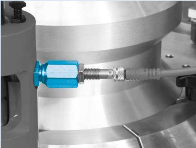
Pressori di controllo per il rilevamento della posizione mediante tradizionali sensori induttivi. In figura la versione compatta con filettatura a passo fine.
