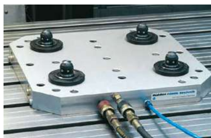
Tavola macchina: Piastra base con 4 moduli
